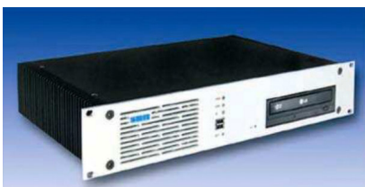
Industrierechner RXT77W im 2HE Rackmountgehäuse
